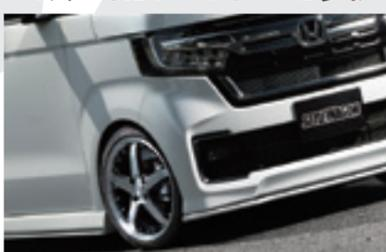
軽カーのインチアップ定番サイズは15～16インチ。ほぼすべての軽カーは、4つのナットで固定され、ナット穴同士の距離を表すP.C.D.は100。軽カーはインチアップ人気が高いので、選択肢はかなり豊富。ミニバンなどに比べるとタイヤ&ホイールのコストを抑えられるのも魅力
