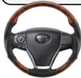
純正エアバッグを流用できる車種専用設計の交換型ステアリングが主流。ウッドやレザー素材の採用に加え、純正と比べ、グリップ部のコブが加わったりと実用性アップが狙えるモデルもある
