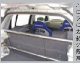
この種のクルマは開口部が広いので、Cピラーの中央から上部に掛けて、バーにより左右のフレームを連結させると、コーナーリングやレーンチェンジの際のリアの追従性が高まる傾向にある
