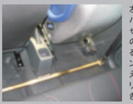
左右のサイドシルをバーによって連結させることで、横方向のボディ剛性を高める。おもにコーナーリングでの振れを抑え、シャープなハンドリングとクルマの動きをもたらす
