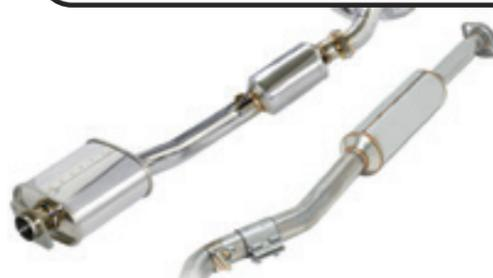
一般にエキゾーストマニホールドにつながる箇所をフロントパイプ、マフラーにつながる箇所をセンターパイプと呼ぶ。キャタライザーはそのつなぎ目からフロントパイプ側、もしくはエキマニ側に位置する
