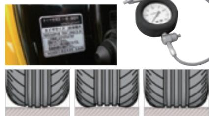
左から高過ぎ・低過ぎ・適正。接地が偏ると操安性が悪化。減りも早い。つねに適正な空気圧で走るよう心掛けたい
