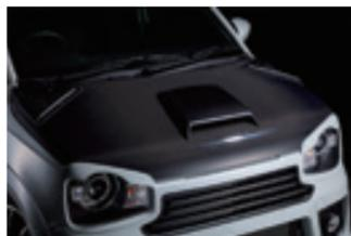
FRPやカーボン製で、アルミはともかく、スチールの純正よりは大幅な軽量化が図れる。同様の効果を狙って、カーボン製のトランクリッドやリアハッチも市販されている。ダクト付きのボンネットはエンジンルームの放熱に寄与
