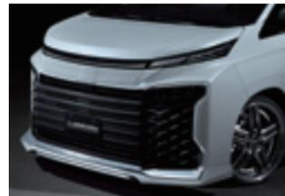
純正バンパーの下に装着するリップスポイラーは、純正のセンサー類に干渉することが少なく、人気が高い。薄くつくられていて、車高ダウンしても路面とのクリアランスも確保しやすい
